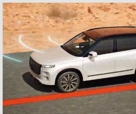
System zapobiegający niekontrolowanej zmianie pasa ruchu (LDP)
